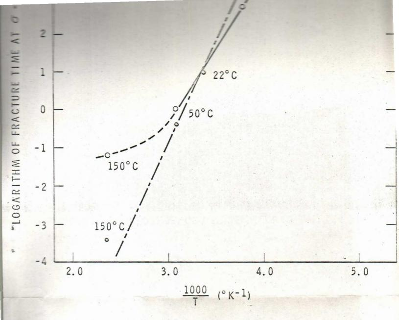
FIGURE 3 TEMPERATURE DEPENDENCE OF THE DELAYED FAILURE PROCESS
