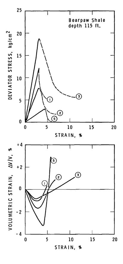
FIGURE 4 CONSOLIDATED DRAINED TRIAXIAL TEST RESULTS - AXIAL STRESS INCREASING
