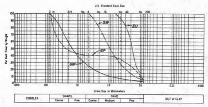
TYPICAL WELL GRADED AND POORLY GRADED SOILS
