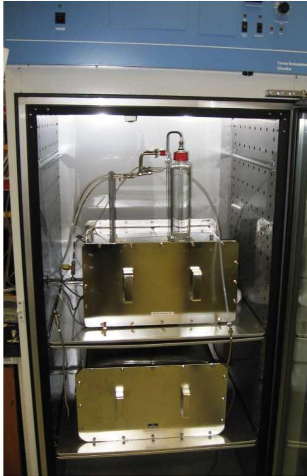
Figure 7-4 : Petite chambre pour analyse de tête des émissions de composants.
