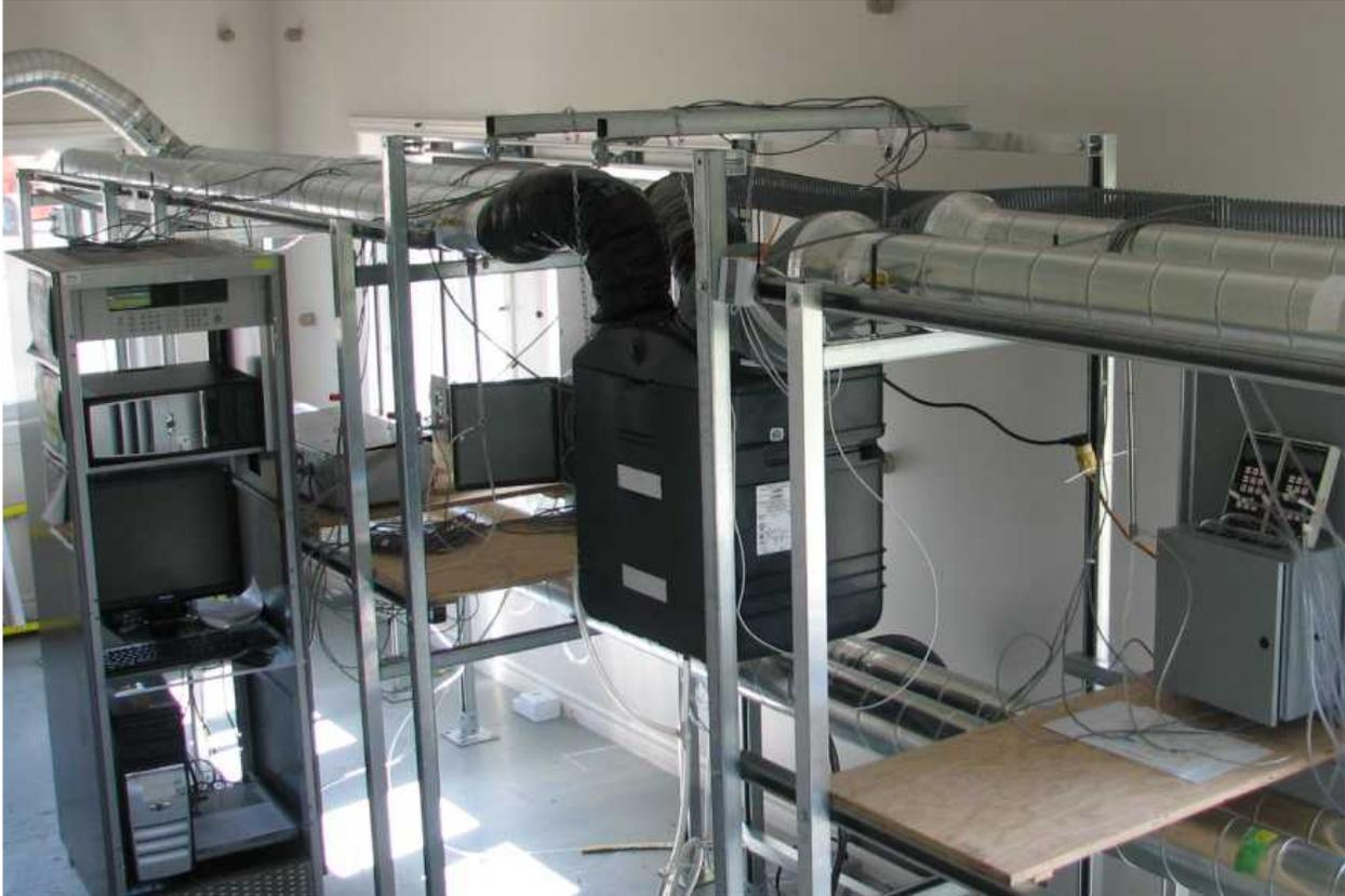
Figure 7-3 : Installation réelle d'un montage d'essai d'un système VRC/VRÉ
