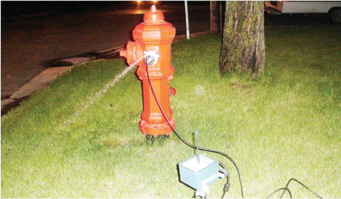
Figure 4. Hydrophone connecté à une borne-fontaine
