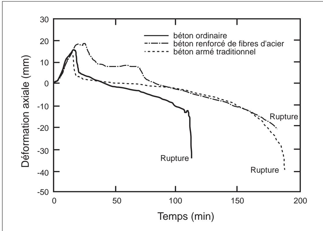
**Figure 2.** Cette figure indique la capacité de résistance au feu d'un PCC typique selon le type de béton employé pour le remplissage. La variation de la déformation axiale en fonction du temps d'exposition au feu témoigne de la meilleure tenue du béton renforcé de fibres d'acier (rupture ductile, c.-à-d. graduelle) par rapport au béton ordinaire (rupture fragile, c.-à-d. soudaine).
