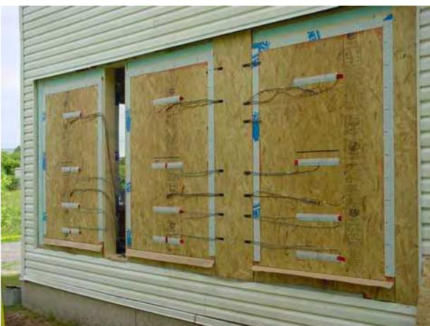
Installation de sondes de mesure sur les panneaux de revêtement intermédiaire des trois échantillons
