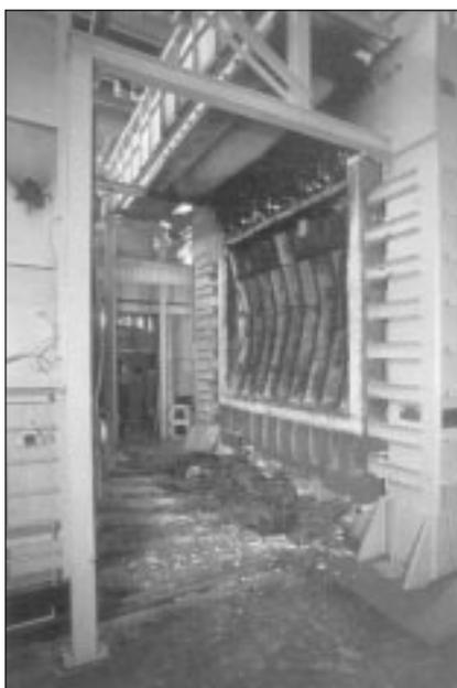
**Figure 1.** Cloison en plaques de plâtre faisant l'objet d'essais dans le four vertical (alimenté au propane) de l'IRC
