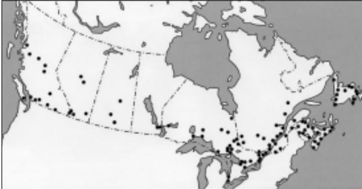
Figure 4. Carte du Canada illustrant l'emplacement des structures touchées par la réaction alcalis-granulats ou des sources connues de granulats réactifs (tirée de la référence 2).
