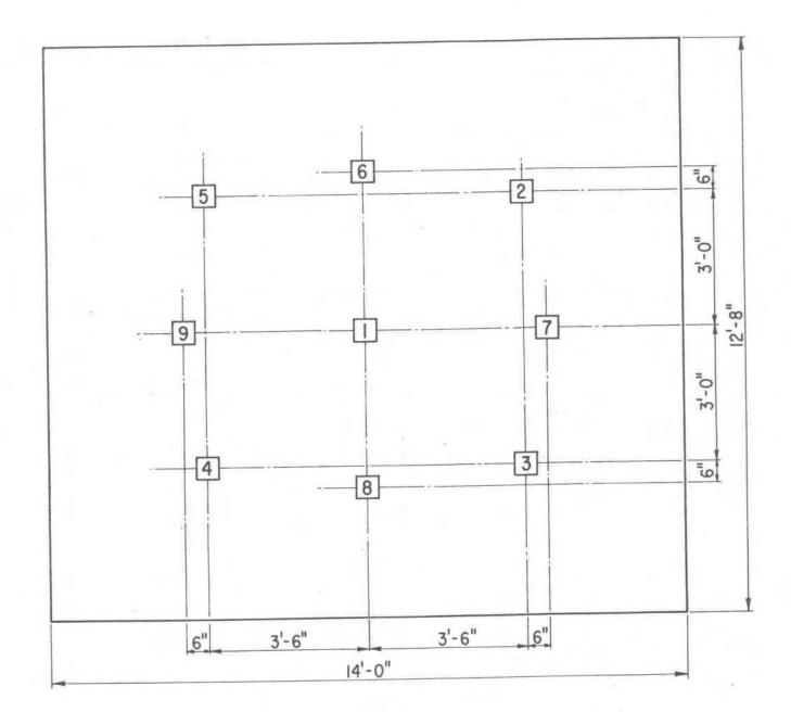
FIGURE 6 LOCATION OF THERMOCOUPLES ON THE UNEXPOSED SURFACE
