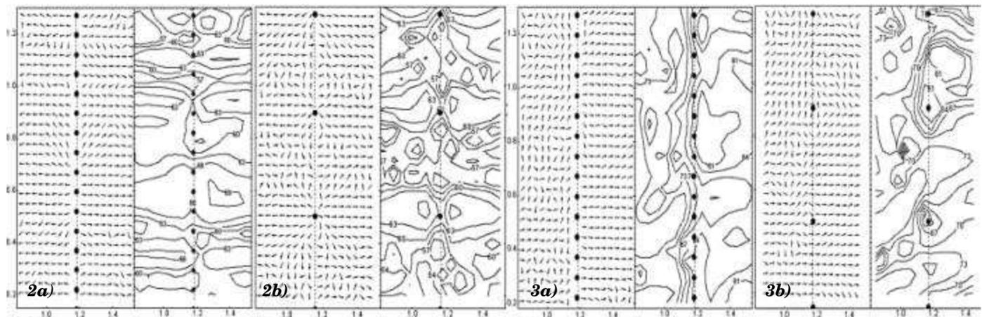
Abb. 2: Intensität (links: Richtung, rechts: Betrag [dB]) auf der Platte bei Anregung der Rippe (a) Rippe mit 16 Schrauben, b) Rippe mit 4 Schrauben an Platte befestigt)
